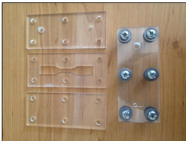
شکل ۱. قالب کشش جهت تولید نمونه‌های استاندارد شامل سوراخ‌هایی جهت ورود کامپوزیت و خروج هوا
